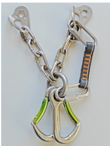
Foto 2: Beispiel für eine vorübergehende behelfsmäßige Hintersicherung.
