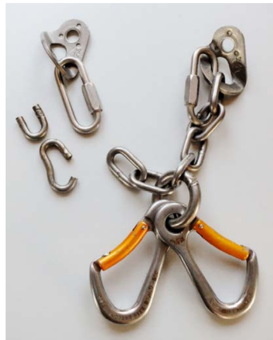
Foto 1: Die FIXE-Ausgleichsverankerung, bei der zwei Kettenglieder gebrochen sind.
